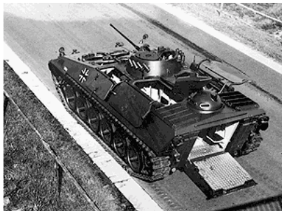
RU 361 von 1966 – die Prototypen des SPz-neu wachsen: hier das erste Fahrzeug mit sechs Laufrollen und erstmals dabei: die Hecklafette
