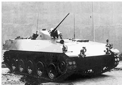
RU 261 aus dem Jahr 1964 – nun ist der gesamte Triebwerksblock im Bug installiert. Im Heck ergab sich damit eine große Ausstiegsöffnung für die Panzergrenadiere
